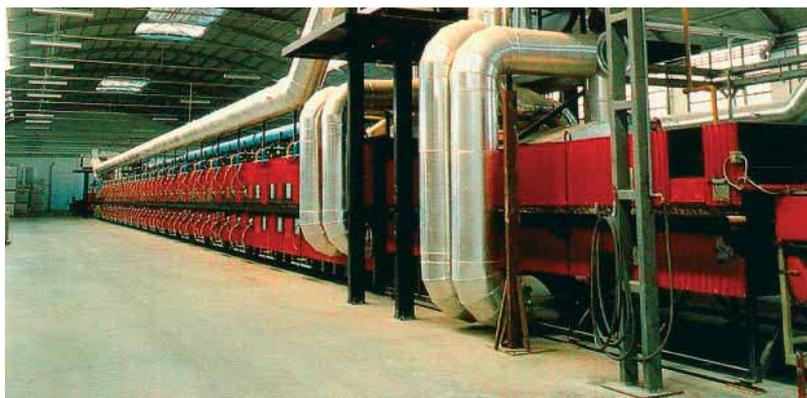
пребывания в течение определенного времени на участке обжига плитка перемещается далее по туннелю, последовательно охлаждаясь до температуры, которая обеспечивает ее безопасную выгрузку из печи. Во время обжига происходят различные реакции, от результата которых, собственно, и зависят характеристики изделия. В условиях высоких температур
